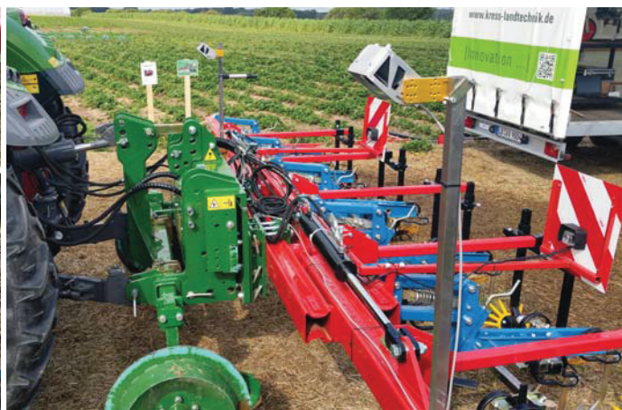
Abb. 4: Feinststeuerung der Fingerhacke mit Kamera und Verschieberahmen.
