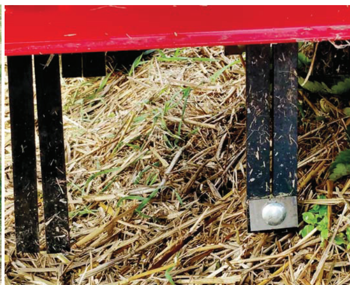
Abb. 7: Metallverstärkung an den Schlegeln des „Erdbeerfuchs“.
