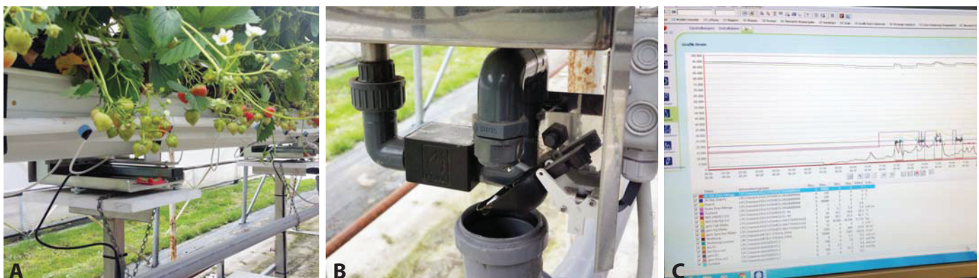
Abb. 15: (A) Messstrecke für Wiegen der Substratkultur; (B) Messung von Drainagemengen und Drainagewasser-EC; (C) Bildschirmanzeige zur Justierung und Einstellung sowie zur Anpassung der Werte.
