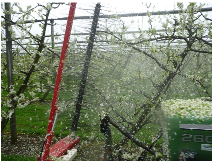
Mechanische Ausdünnung bei Zwetschgen mit Darwin in einer Drapeau-Anlage (Güttingen).
