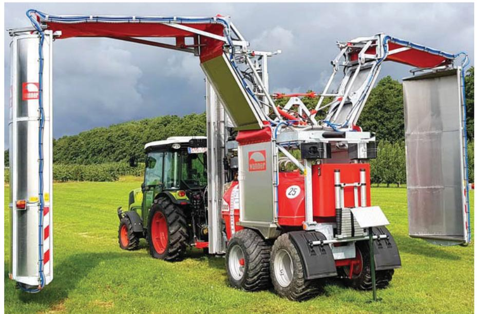
Abb. 4: Das 2-reihige Reflektorsprühgerät Wanner NTR 20.
