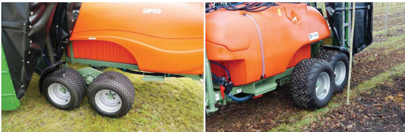
Abb. 2b: Links: Standard-Pendeltandemachse (beide Räder werden gleichzeitig hydraulisch verstellt); rechts: Tandemachse (nur die vordere Achse ist breitenverstellbar).
