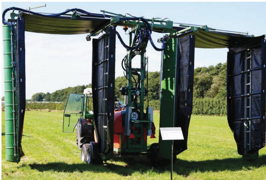
Abb. 2a: Das 2-reihige Tunnelsprühgerät LIPCO OSG-NVM 2.
