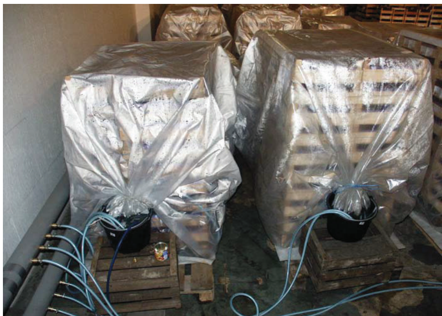
Abb. 5: Eine Ringleitung mit angeschlossenen Lagerbeuteln hält in allen Beuteln die gleichen CA-Werte. Einfaches An- und Abkoppeln machen diese Methode sehr flexibel.
