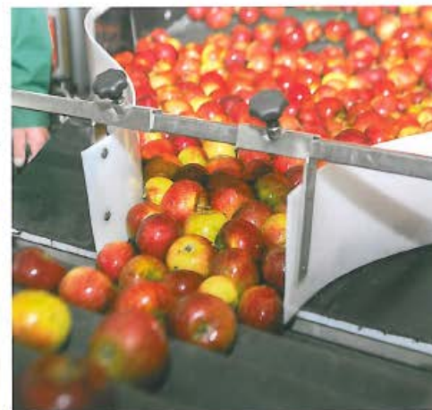
Æblerne hældes fra storkassen ud på slisen, der fjerner dem til det varme vand. Båndbredden bestemmer sorteringshastigheden.
