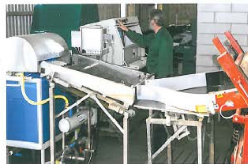
Varmtvandsanlæg, sortering og pakning er bygget sammen i én proceslinje. Poul Rytter Larsen har til denne sæson købt en brugt optisk sorteringsmaskine fra forsøgscentret i Århus og brugt pakkerudstyr fra SAF's frugtlager i Kværndrup.
