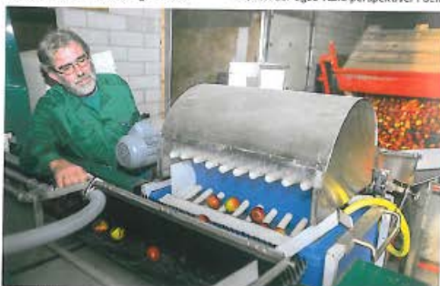
Økologisk frugtavl Poul Rytter Larsen, Harndrup Skov Frugtplantage, er i gang med at teste anlægget med varmt vand på en kasse æbler til frisk konsum. Bassinet nummer 200 liter vand, der er 54°C, og æblerne dyppes i 30 sekunder, inden de transporteres videre gennem en optisk sortering.
