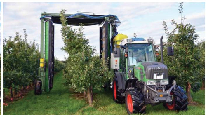
Abb. 1, 2: Einreihiges Tunnelsprühgerät LIPCO OSG-N1 - P.A.U.L.
