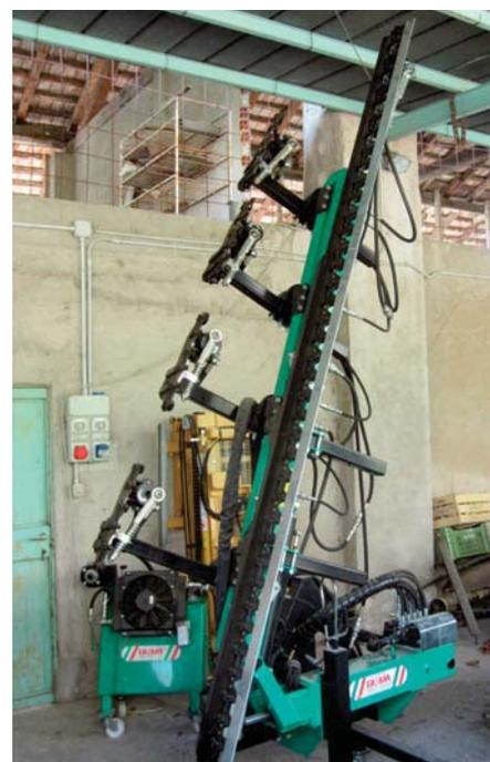
Abb. 20: Schnittgerät der Fa. FAMA mit zusätzlichen Messersegmenten für den Schnitt eines Lichtfensters.
