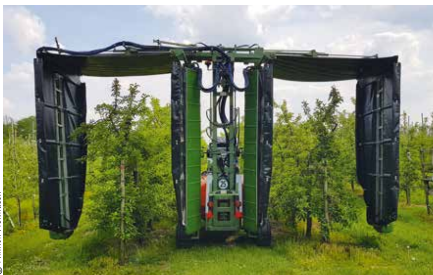
> DES PULVÉRISATEURS « TUNNEL » POUR RÉDUIRE LES ÉMISSIONS DANS L'ENVIRONNEMENT
