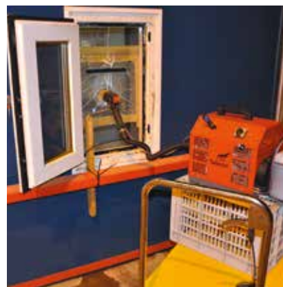
> NÉBULISATION D'AGENTS DE BIOCONTRÔLE EN CHAMBRE FROIDE
