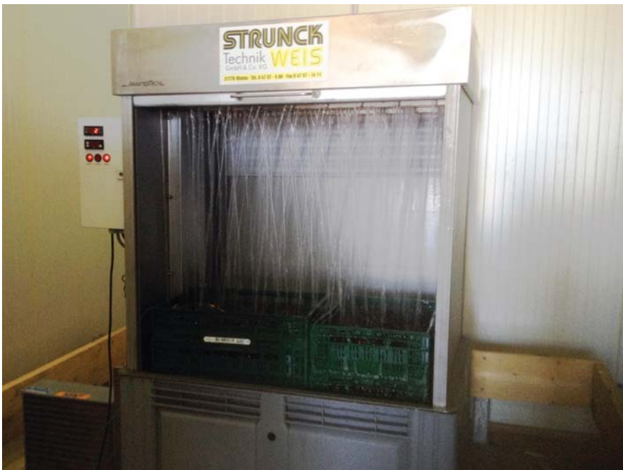
Abb. 1: Eiswasserkühler der Firma Strunck-Weis in Aktion.
