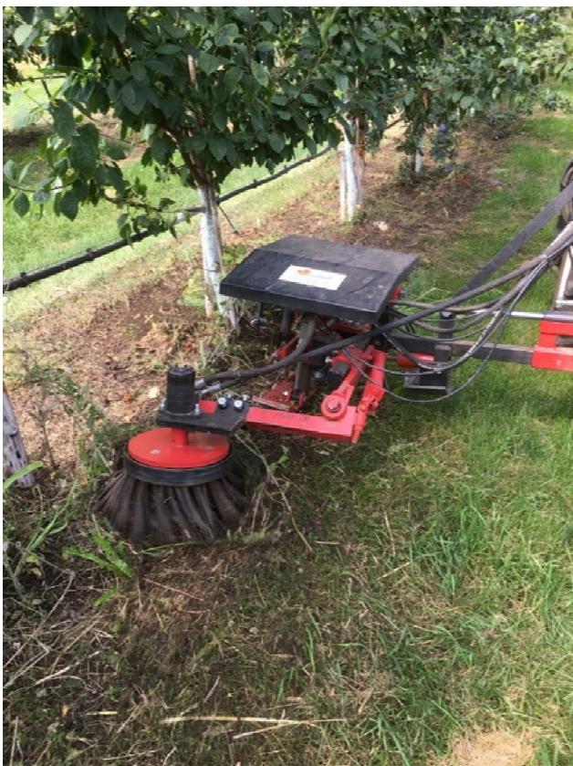
Abbildung 6: Bearbeitung des Baumstreifens mit dem Bürstengerät „Natura Griff“ am 25.08.2017.
