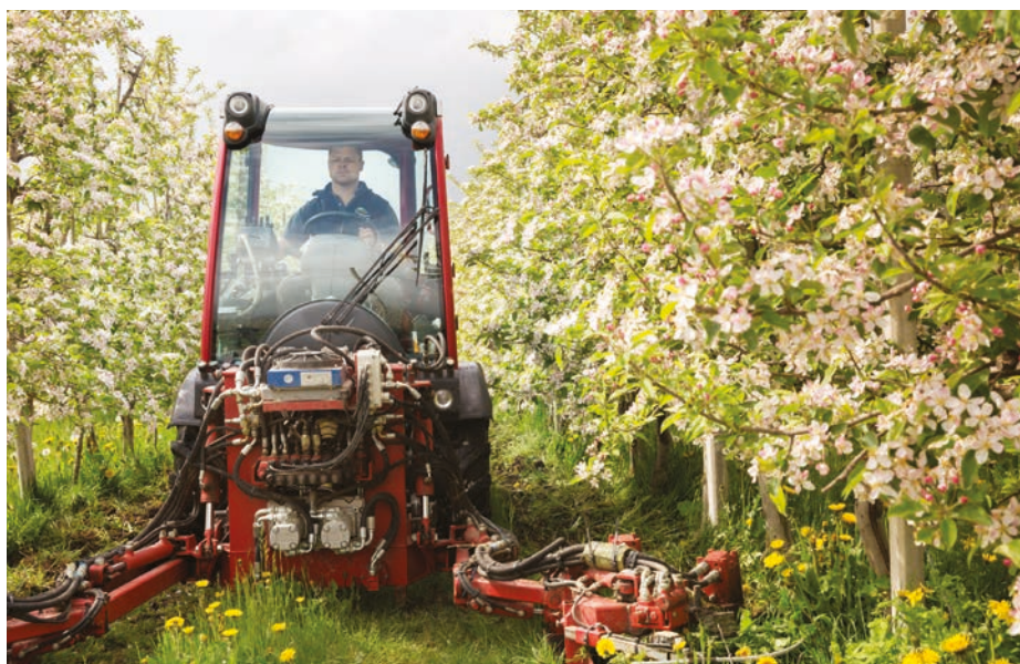
▲ Fig. 7 - Erpice rotante per la gestione del filare di meleto biologico sviluppata da un'azienda artigianale locale.
