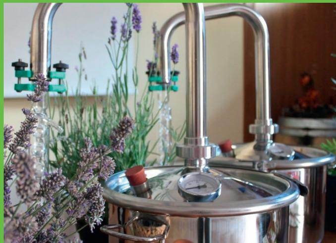
Clevenger-Apparat zur Wasserdampfdestillation
